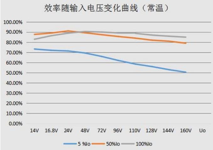
UWTH1D54LD-30WR3 效率随输入电压变化曲线 (常温)
