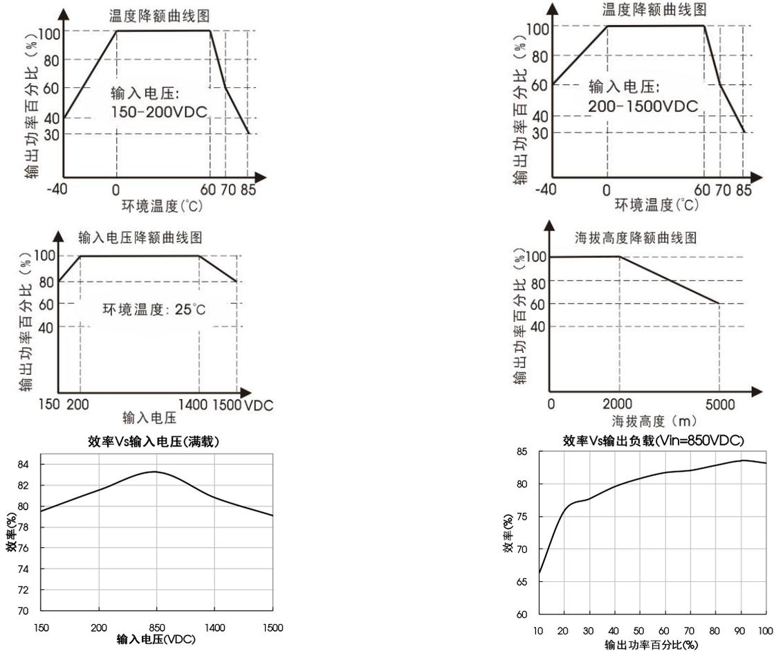
注：①对于输入电压为 150 - 200VDC, 1400VDC - 1500VDC，产品需在温度降额的基础上进行电压降额；
