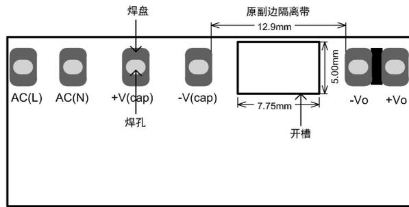
注：4、5脚隔离带侧开槽（非金属孔）；具体尺寸请参考外观尺寸图中的推荐焊孔设计。
