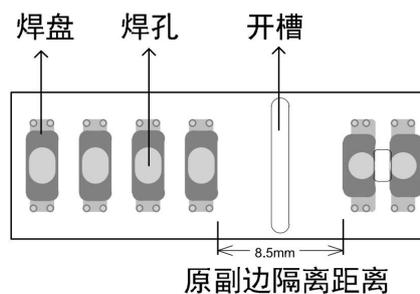
注: 4、5脚隔离带间开槽(非金属孔), 具体尺寸请参考外观尺寸图中的推荐焊孔设计。
