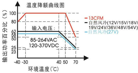
注: 对于输入电压 85 - 115VAC/120 - 160VDC 需在温度降额的基础上进行输入电压降额。
