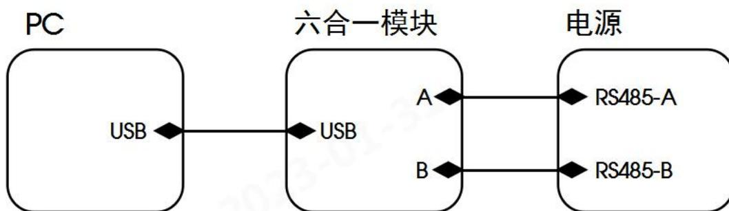
即：将信号端子的 RS485-A 与 RS485-B 接入到 USB 接口模块
