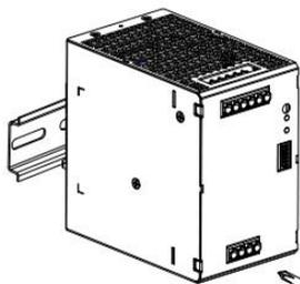
⑤用十字螺丝刀把端子螺丝松开,把导线头部插进端子下后再把端子螺丝锁紧;
