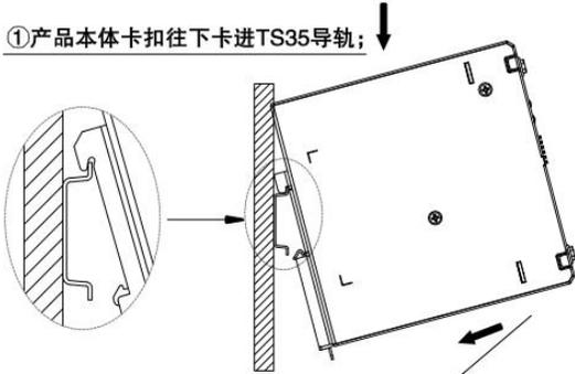
②把产品本体垂直TS35导轨方向推,直到听到卡扣卡入导轨的声音;
