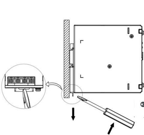
③用一字螺丝刀卡进卡扣底部方槽后,按图示方向把卡扣滑块部分往下顶;
