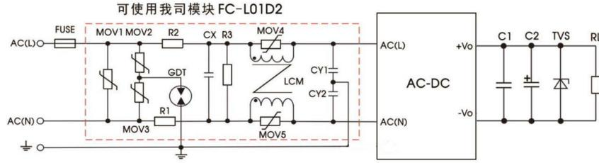
图 2: EMC 更高要求推荐电路
