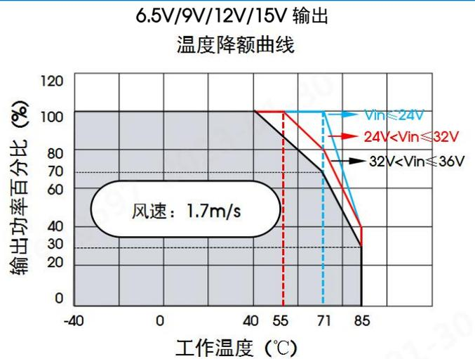
图 1-① 强制风冷曲线 (正输出)
