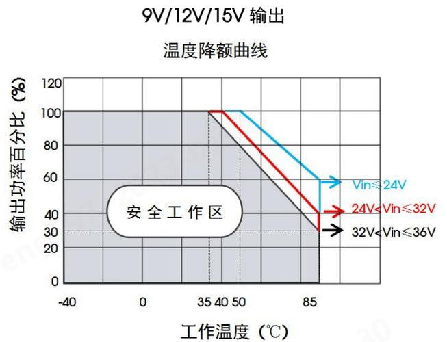
图 1-② 自然空冷曲线 (正输出)
